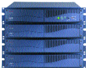
Pulsar EXtreme 1500 C + 3 Pulsar EXB : 80 min d'autonomie à pleine charge
